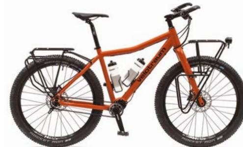
**FINDER** | Eine geniale und vielseitige Mischung aus Bikepacking- und Adventure-Reiserad für Touren abseits des Asphalt. Mit Kettenschaltung, Rohloff-Nabe oder Pinion-Getriebe. Rahmengrößen S bis XXXL.
